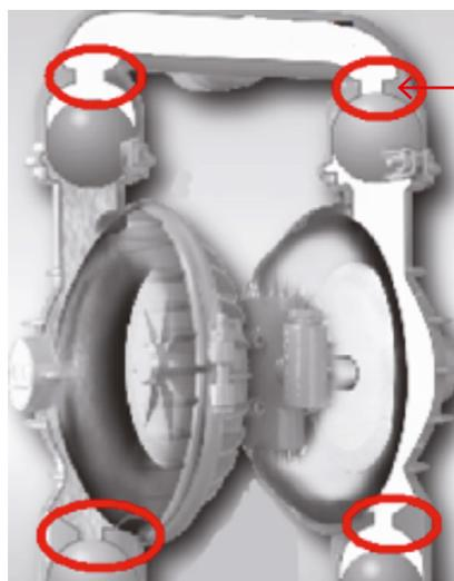
Abrasive Medien führen zu schnellem Verschleiß der Kugelstopper
