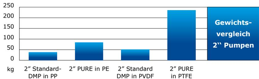
Massive Druckluftmembranpumpen haben ein höheres Gewicht als Standard-Druckluftmembranpumpen (DMP) und bieten daher eine leisere und vibrationsärmere Förderung
